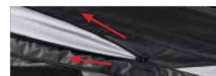
Rozšiřitelná část Zipy umožňující rozšířit prostor podle velikosti nákladu (Thule Ranger 500).
