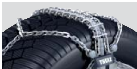
Řetěz spojující přední a zadní stranu Speciální ocelové články, které jsou spojeny ve zvláštním tvaru "S", propojují středovou vzpěru s vnitřním tuhým obloukem.
