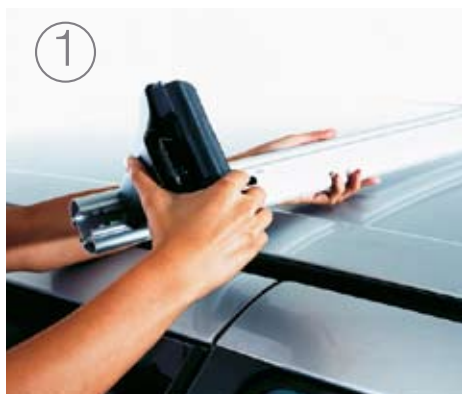
1 Patku nasuňte na nosnou tyč. Seřídte podle stupnice na tyči a usazenou patku zajistěte.
